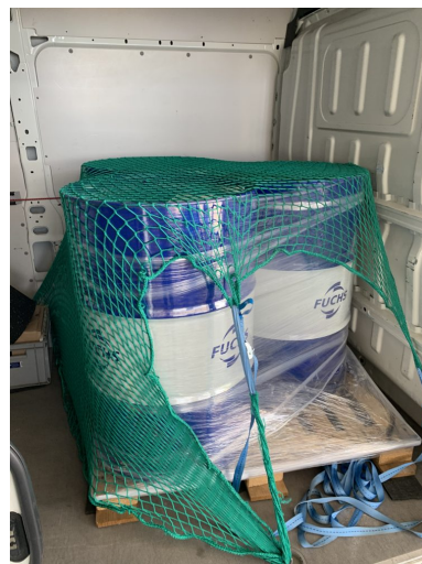
Fässer auf Palette mit Ladungssicherungsnetz gesichert
