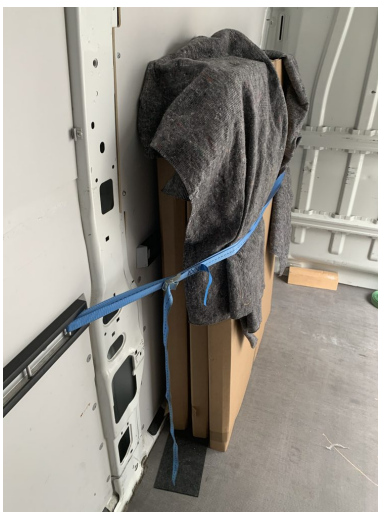
Ware mit Zurrgurt an der Zurrchiene gesichert, Antirutschmatte
